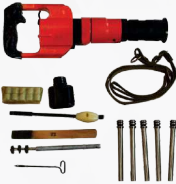
“ПЦ-84” დუბადის დიამეტრი 8, 10, 12 მმ Dowel diameter 8, 10, 12 mm
